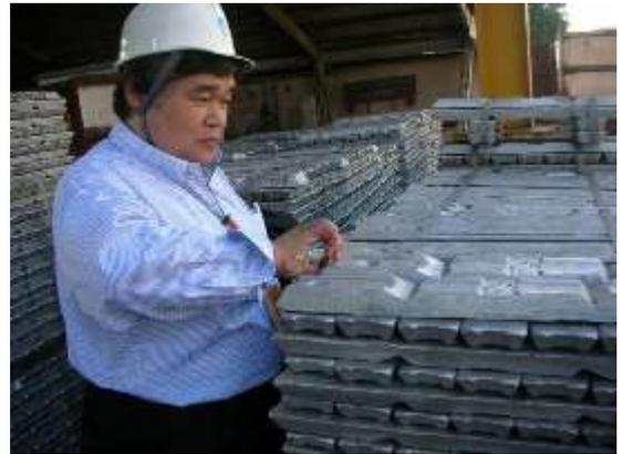
インゴットに数種の金属を加えて溶解したあとは、長さ 6 m の丸棒に。
