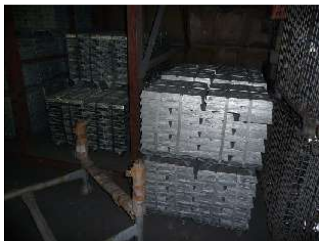
めっき槽で450度前後に溶かされる亜鉛インゴット
